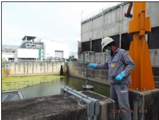
รูปที่ 3.4 การเก็บตัวอย่างคุณภาพน้ำทิ้ง บริเวณบ่อพักน้ำทิ้งของโครงการ (Retention Pond)
