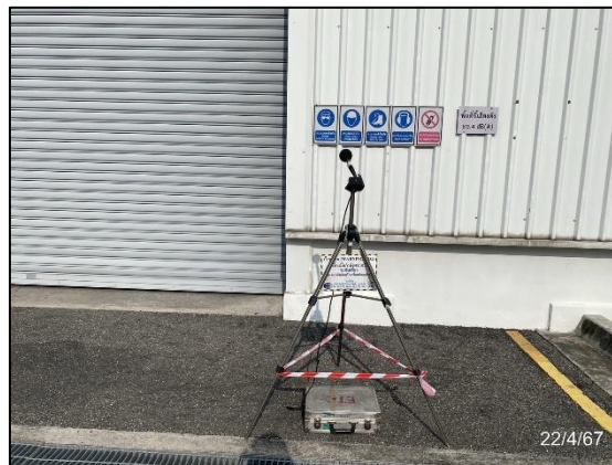
รูปที่ 3.8 การตรวจวัดระดับเสียงในพื้นที่ทำงาน บริเวณ เครื่องผลิตไฟฟ้ากังหันไอน้ำ
