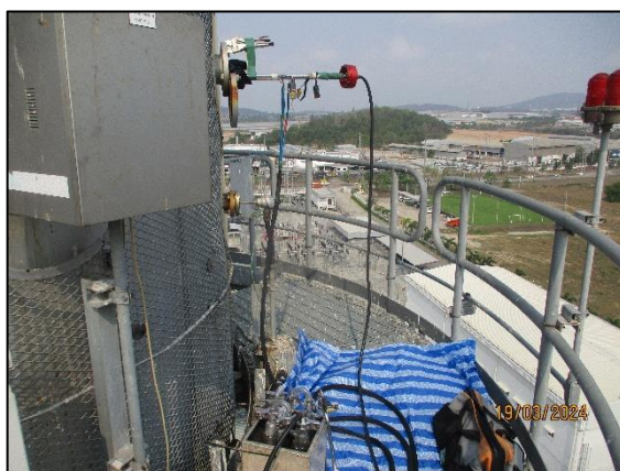
รูปที่ 3.2 การเก็บตัวอย่างคุณภาพอากาศในปล่องระบาย บริเวณ ปล่องระบายหน่วยผลิตไอน้ำ HRSG 12
