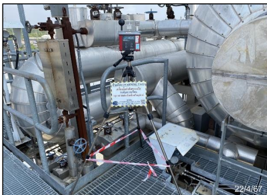
รูปที่ 3.11 การตรวจวัดระดับความร้อนในพื้นที่ทำงาน บริเวณ หม้อไอน้ำ
