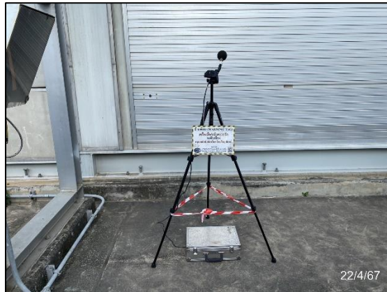
รูปที่ 3.10 การตรวจวัดระดับเสียงในพื้นที่ทำงาน บริเวณ Chiller
