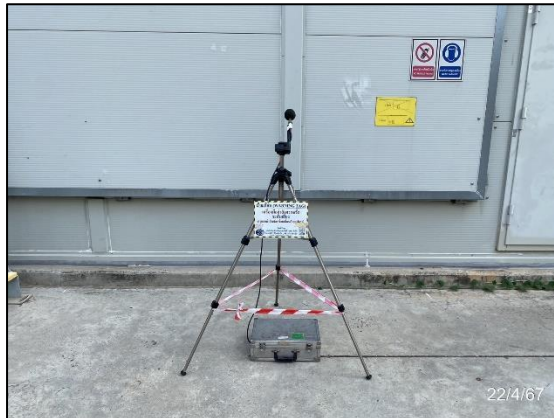
รูปที่ 3.7 การตรวจวัดระดับเสียงในพื้นที่ทำงาน บริเวณ เครื่องผลิตไฟฟ้ากังหันก๊าซ
